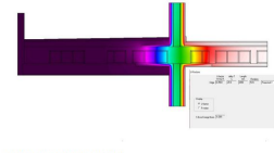
planta, pilar de fachada sección, raíz de columnas CÁLCULO DE TRANSMISIÓN LINEAL U=2,0,3564 - 2x6,19=0,5322 W/m²K
